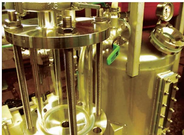
アロマの抽出には一般的に水蒸気蒸留法で行われることが多く、「アロマ減圧水蒸気蒸留装置」も同じ方法で抽出します。
